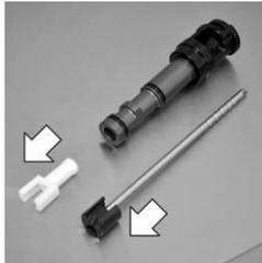
Retirer le joint de l'arbre du centrifugeur, en utilisant l'outil d'installation/désinstallation.
