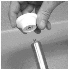
**6 Retirer l'écrou du piston.**
