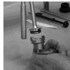
**15 Retirez les joints toriques du corps de la vanne et du bec.**
