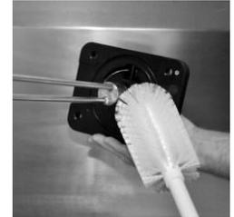
Brosser complètement toutes les pièces démontées et les plateaux de pièces dans la solution nettoyante, en s'assurant qu'il n'y a plus de lubrifiant, ni de film de mélange. Veiller à nettoyer toutes les surfaces.
