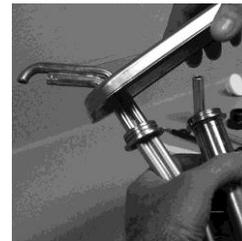
**13 Retirer le cylindre du piston du corps de la vanne.**
