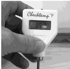
La température du mélange doit se trouver entre 34 ° et 38 °F (1 ° et 3 °C). Si le relevé de température ne se trouve pas entre ces températures, contacter votre centre d'entretien agréé par le fabricant.
