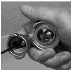
Déplacer la brosse d'avant en arrière rapidement pour frotter le passage. Retirer la brosse du corps de la vanne.
