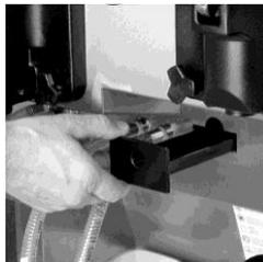
**Remarque :** La présence de mélange dans les bacs ramasse-gouttes indique qu'il existe une fuite qui doit être corrigée avant que des dommages se produisent à l'intérieur de la machine.
