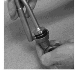
Pousser le bec jusqu'à ce qu'il soit assis dans l'ouverture du corps de la vanne. Tourner le bec dans le sens des aiguilles d'une montre, pour l'enclencher entièrement dans les rainures de blocage du corps de la vanne.
