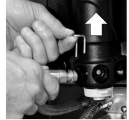
Insérer les bouchons dans les orifices d'arrivée de sirop.
