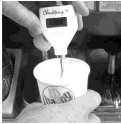
La température doit se trouver entre 16 ° et 18 °F (-9 ° et -8 °C). Si le relevé de température ne se trouve pas entre ces températures, contacter votre centre d'entretien agréé par le fabricant.
