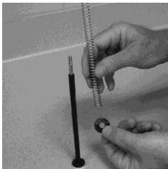
**9 Retirer l'assemblage du joint.**
