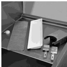
Placer le bouchon du restricteur, le déflecteur, le tiroir ramasse-gouttes et le porte-gobelets à shake sur une surface propre et sèche et laisser sécher à l'air jusqu'au lendemain ou jusqu'à ce que le cycle de chauffe soit terminé.
