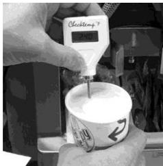
Le relevé de température appropriée pour des Shakes triplement épais se situe entre 22 ° et 24 °F (-5 ° et -4 °C). Si le relevé de température ne se trouve pas entre ces températures, contacter votre centre d'entretien agréé par le fabricant.
